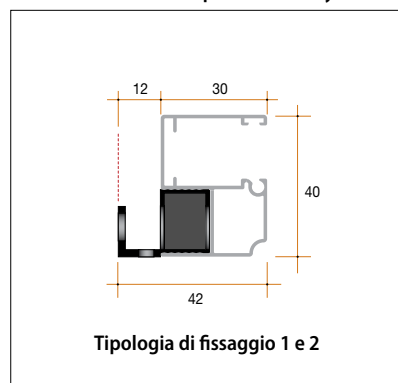
Guida antivento e compensatore in nylon
