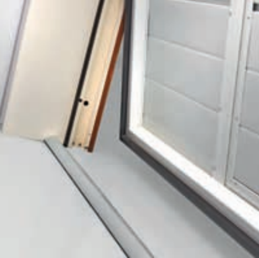
Soglia di battuta in alluminio montata internamente al basculante per proteggere da agenti atmosferici o compensare irregolarità del pavimento Aluminium striking threshold fitted internally to the up and over door to protect it from the weathering agents or to compensate floor irregularities
